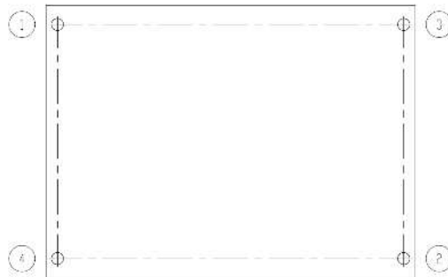
図 4-3 ボルトの締付け順序 (例)
