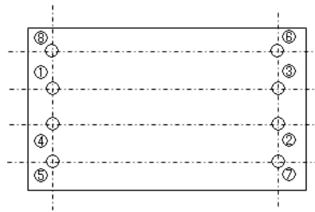
図 4-7 ボルトの締付順序 (例)
